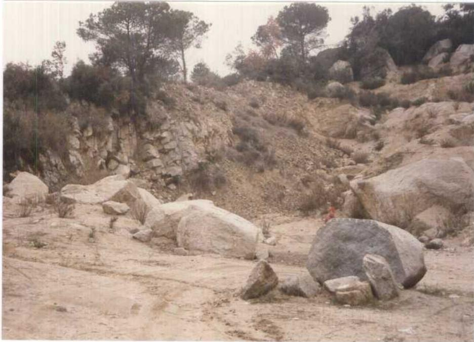
Foto 60 (71/K13).- Hoja 393. Cantera abandonada en la que se observan procesos de meteorización diferencial. Indicio 393-7.
